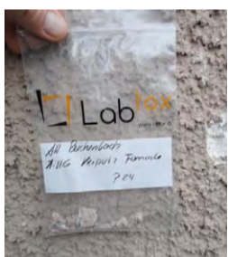
Asbest in Mauerverputz.
